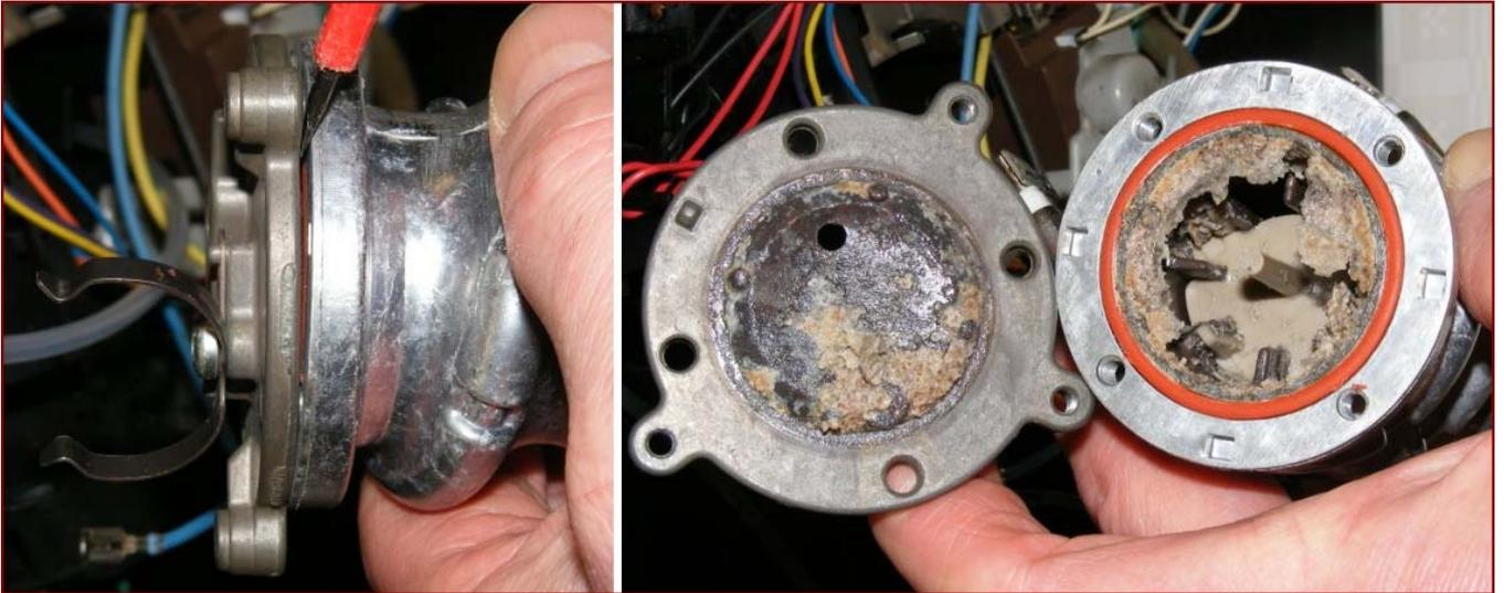
Deckel ggfs. mit einem kleinen Schlitzschraubendreher anheben und öffnen.
