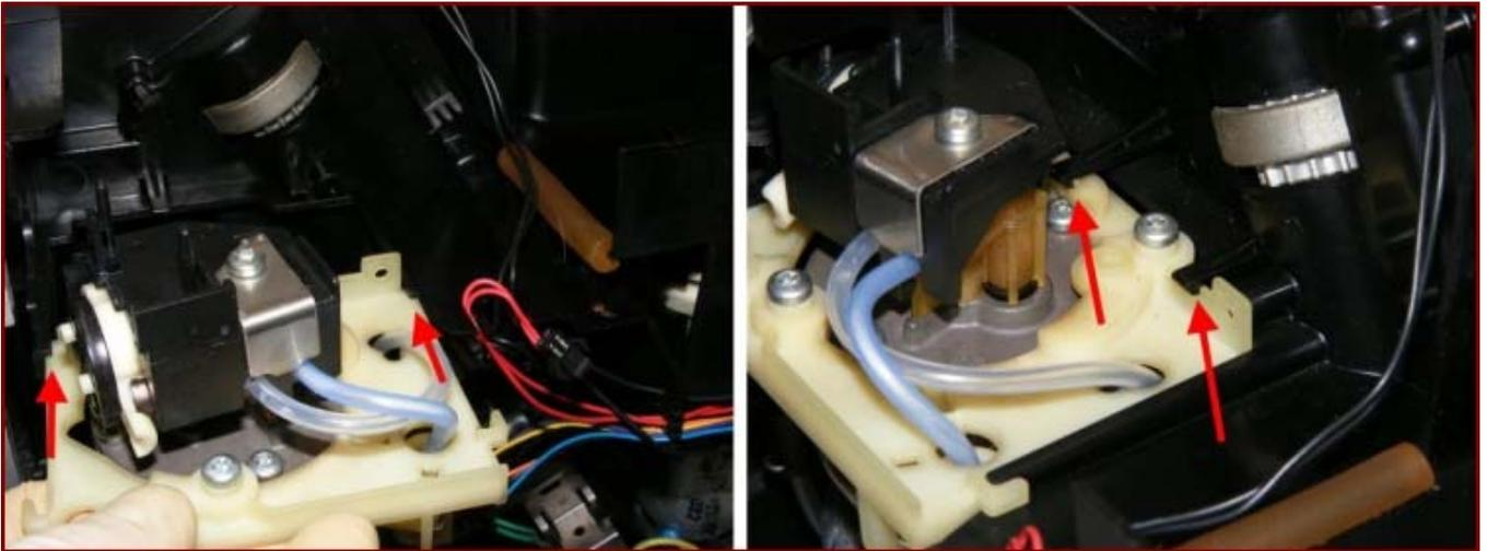
Heizpatronenträger wieder in die Führungen einfädeln und durchschieben, bis die Haken zum festsetzen der Heizpatronenträgerplatte eingerastet sind.
