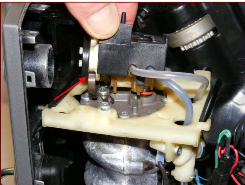
Das Dampfventil kann jetzt nach oben abgenommen werden – insbesondere an der Klammer am Drehregler (roter Pfeil) wird es etwas hakeln.
